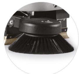
Spazzola laterale: è indispensabile per pulire gli angoli e lungo i muri. Nel caso di pavimenti molto impolverati, per evitare di alzare la polvere, si può sollevare la spazzola, che arresta la propria rotazione.
