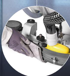
Per assicurare un'asciugatura sempre perfetta è fondamentale eseguire al termine di ogni intervento la pulizia del tubo aspirazione e delle gomme del tergilavaggio. Quest'ultimo si può sollevare per permettere di accedere alle gomme con facilità e pulirle rapidamente.
