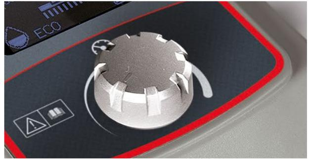
Pratica manopola per aumentare o diminuire la velocità secondo le necessità operative. Il pulsante di sicurezza posto sotto il cruscotto permette di arrestare immediatamente la macchina in caso di emergenza.
